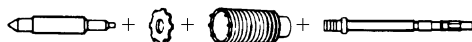
(1) Pino central (chapa guia) (2) Núcleo da broca (3) Haste do núcleo da broca
